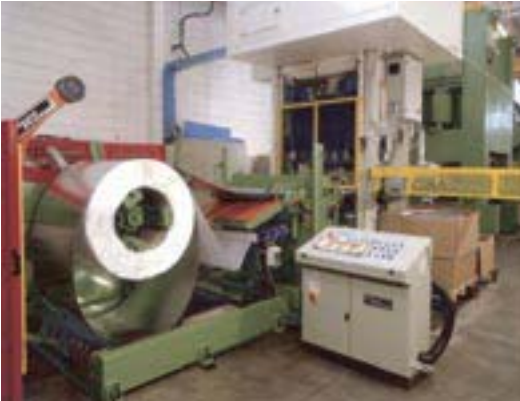
Vollautomatische Presse für Reflektorproduktion
